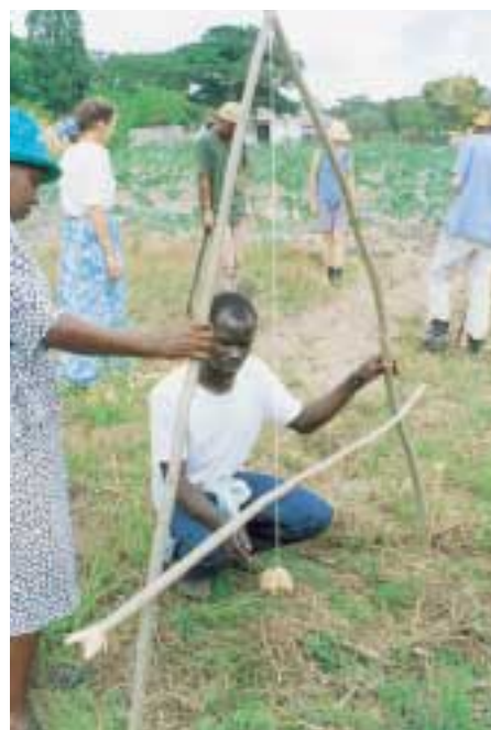
Les participants à un atelier sur la conservation du sol et l'aménagement de l'espace rural organisé par l'association PELUM apprennent à employer un « cadre en A », un niveau de conception rudimentaire destiné à déterminer les courbes de niveau sur une pente (Photo : PELUM)
